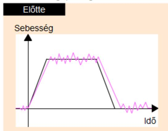
Rezgéscsillapítás-vezérlés és robotus szűrőbeállítás egy érintéssel.
