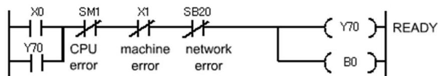
Program sekuens menggunakan kombinasi sinyal status yang berbeda-beda dari modul CPU PLC, mesin, , dll. untuk operasi interlock.
