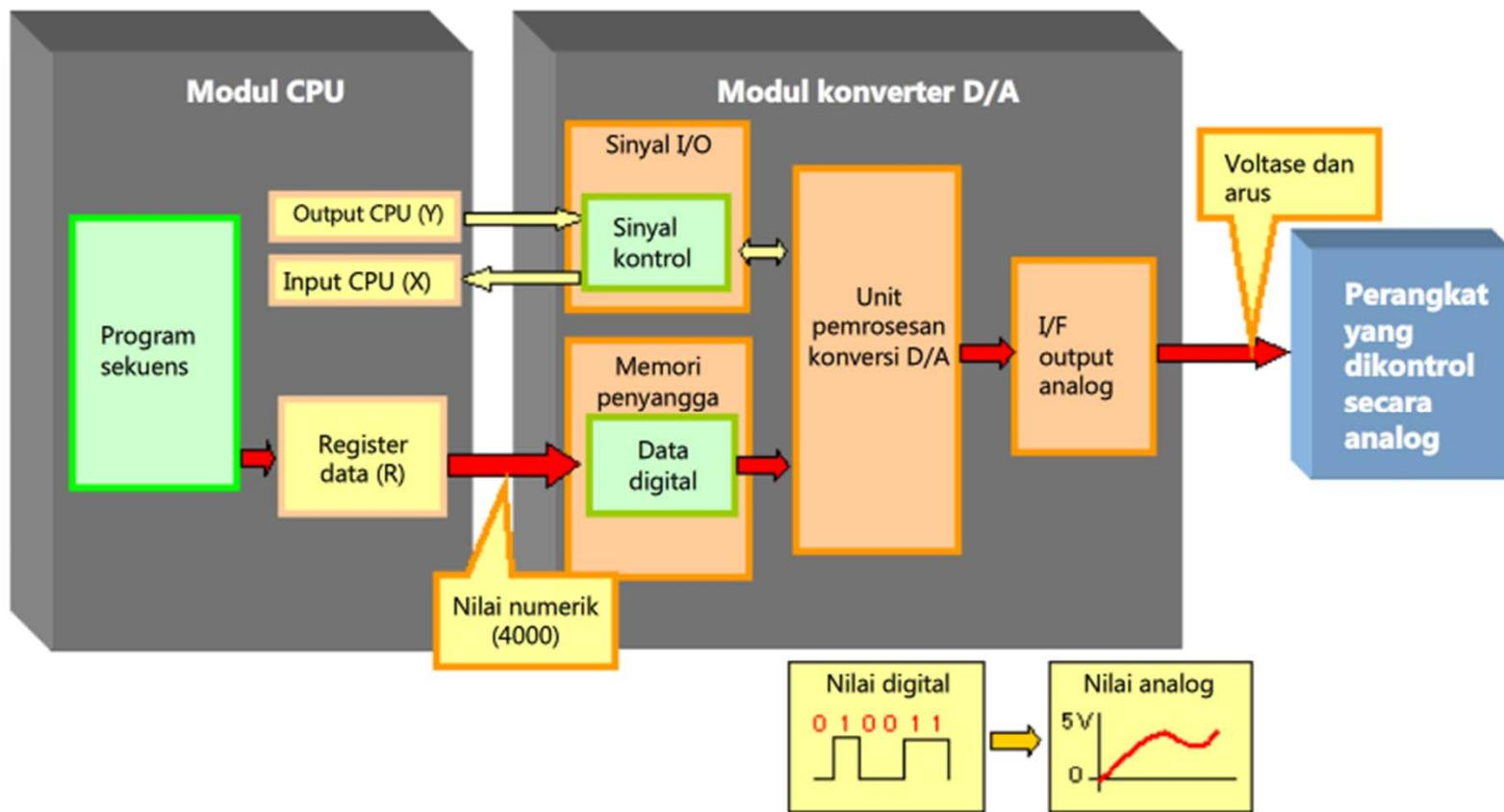
Modul konverter D/A mengonversi data digital yang diatur oleh program sekuens menjadi data analog (voltase atau arus), dan kemudian mengeluarkan data tersebut ke perangkat eksternal. Detailnya dijelaskan di Bab 2.
