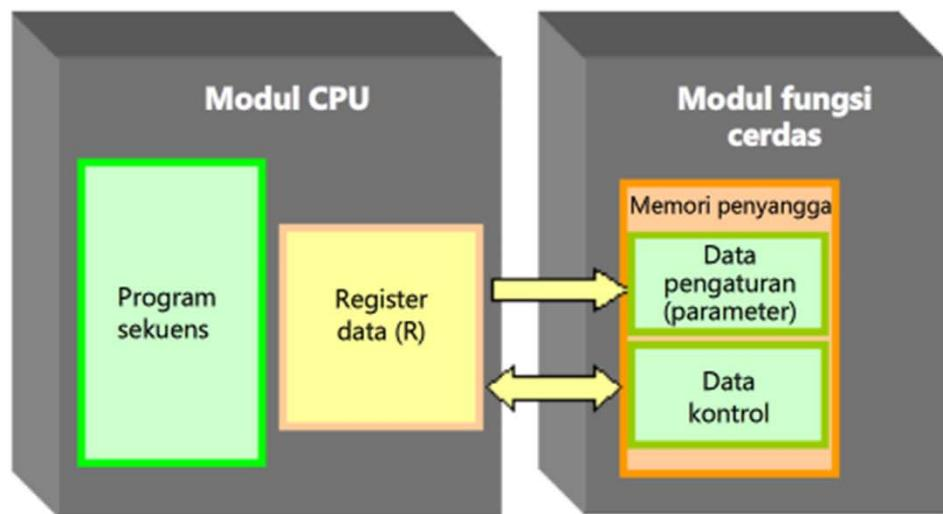
Contoh data pengaturan (dalam modul konverter D/A)
