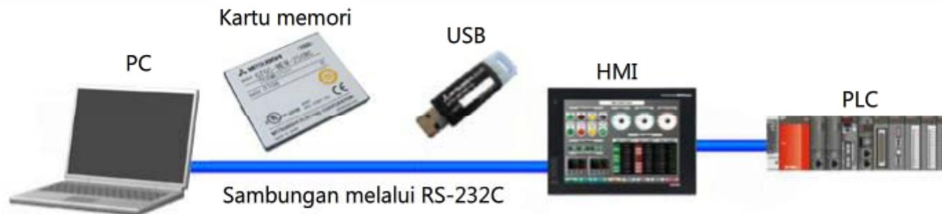
Dengan menggunakan simulator HMI misalnya GT Simulator3 dari Mitsubishi Electric, pengguna dapat menggunakan PC untuk memeriksa pengoperasian layar tanpa perlu menyambung ke HMI.
