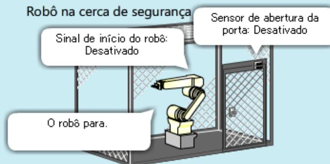
Se você colocar o **interruptor de partida** na posição OFF, o sinal de início do robô será desativado para parar o funcionamento do robô. Ao mesmo tempo, a **luz de funcionamento** se apaga no painel de controle e a **luz de parada** se acende.
