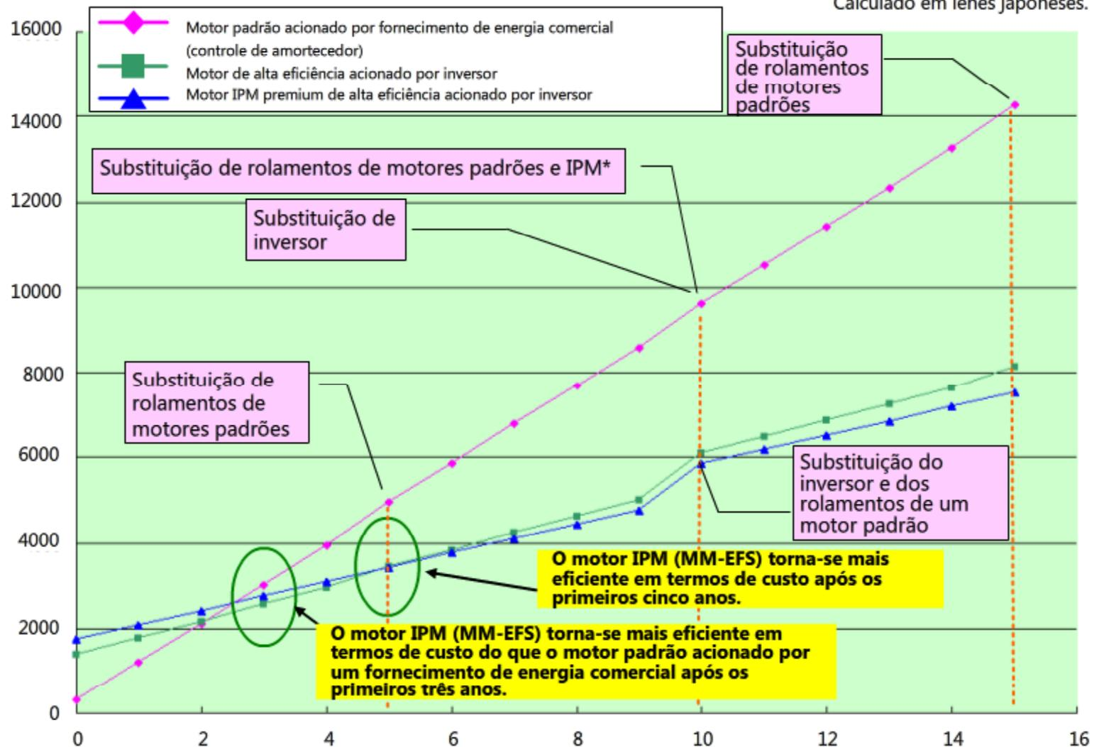
\* O ciclo de substituição dos rolamentos do motor IPM é de 10 anos, o que é duas vezes mais longo do que o dos rolamentos do motor padrão.
