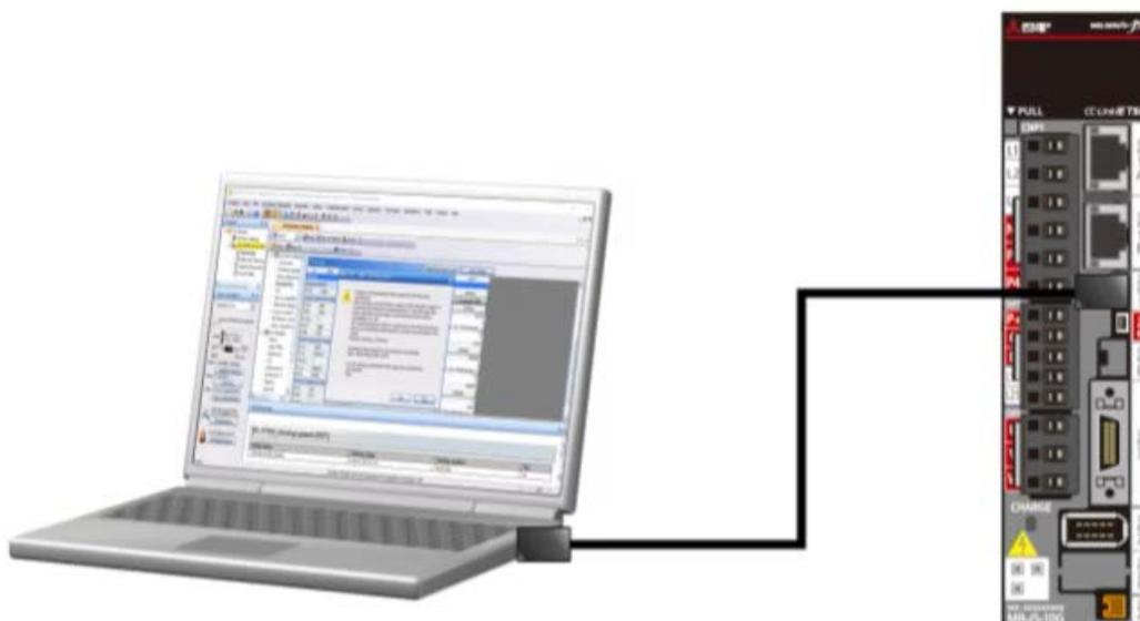
Conecte o PC e o CN5 do servo amplificador usando um cabo USB.
