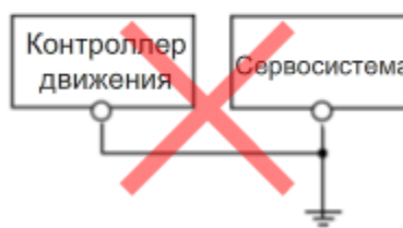
(1) Независимое заземление: Отлично (2) Общее заземление: Хорошо (3) Совместное заземление: Недопустимо
