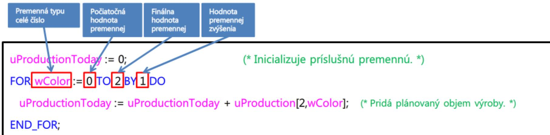
Použitím príkazu FOR sa hodnota premennej „wColor“ v porovnaní s počiatočnou hodnotou nula zvýši o jednu a príkaz sa opakuje, kým premená nedosiahne finálnu hodnotu dva.
