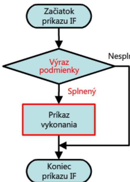
V nasledujúcom príklade je zobrazené vetvenie programu porovnávaním hodnôt premenných. V tomto príklade programu sa ohrievač zapne, keď teplota na ovládacom paneli klesne pod 0 stupňov.
