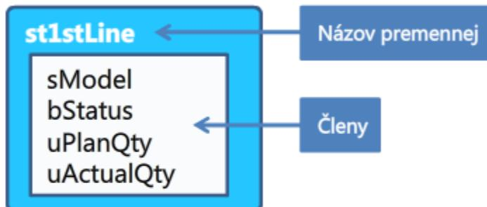
Parameter **structure variable** (premenná štruktúry) obsahuje predponu „st“, ktorá signalizuje, že ide o štruktúru. Jednotlivé premenné definované štruktúrou sú známe ako členy. Typy údajov jednotlivých členov sa môžu lísiť.
