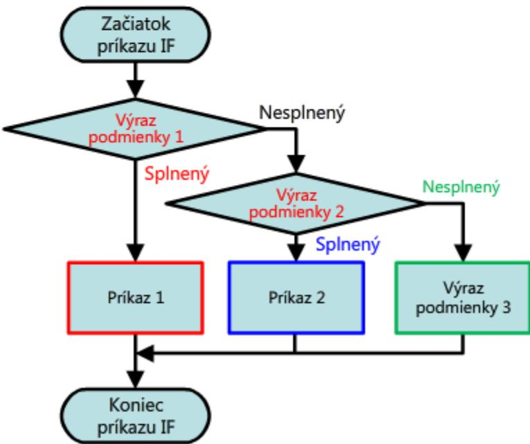
Príkaz ELSIF sme pridali do príkladu programu v časti 5.1.2, aby sme vyriešili situáciu, keď teplota prekročí 40 stupňov.
