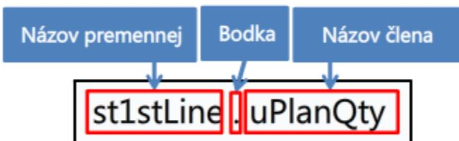
V nasledujúcom príklade programu je členovi premennej štruktúry pre prvú výrobnú linku pridelená konštantá.
