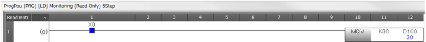
Los valores actuales del dispositivo se pueden cambiar de manera forzada durante la monitorización. (Cambio del valor actual) Con la función de cambio del valor actual, se pueden hacer cambios sin editar todo el programa o ejecutarlo en el sistema real.
