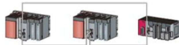
**Topología de anillo: Configuración de conexión circular**
