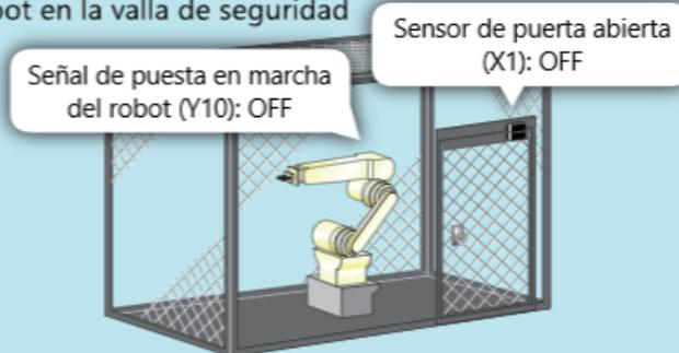
En el estado inicial, el robot se detiene y la **lámpara de parada (Y1F)** se ilumina en el panel de control.
