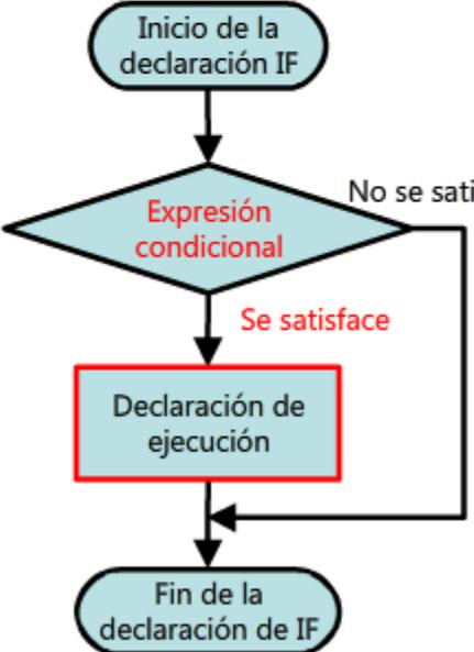
El siguiente ejemplo ilustra la ramificación del programa mediante la comparación de valores de variables. En el programa de ejemplo, el calefactor se enciende cuando la temperatura en el panel de control es menor a 0 grados.
