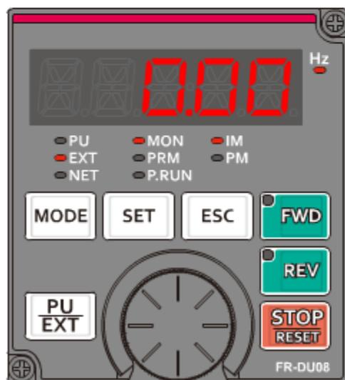
El inversor ahora está en el External operation mode (modo de operación externa). La operación para el cambio entre la operación externa y el PU operation mode (modo de operación PU) está completo.
