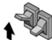
Interruptores de arranque (rotación directa, rotación inversa)
