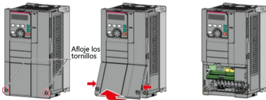
**■ Reinstalación de la cubierta del bloque de terminales: FR-A820-30K o inferior, FR-A840-30K o inferior**
