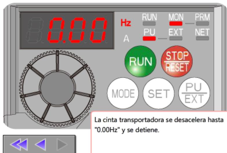
La cinta transportadora se desacelera hasta "0.00Hz" y se detiene.
