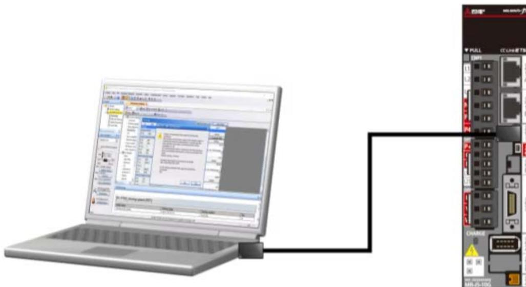
Conecte la computadora personal y el CN5 del servoamplificador con un cable USB.
