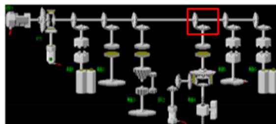
$$\text{Número de pulsos del eje de salida} = (\text{Número de pulsos del eje de entrada}) \times (\text{Radio de engranaje}) [\text{PLS}]$$
