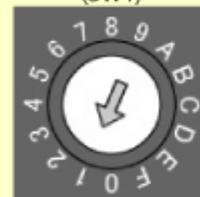
Interruptor de ajuste de número de eje auxiliar (SW2)
