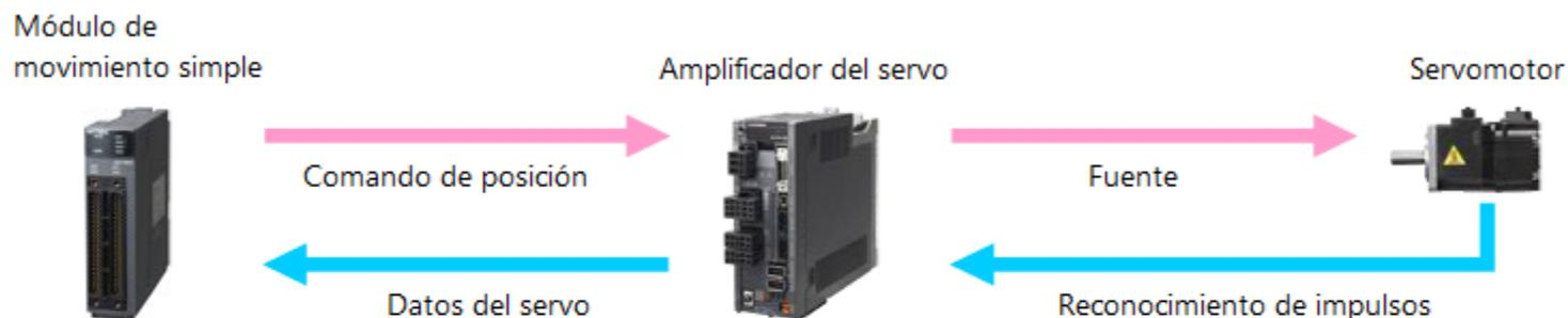
El amplificador del servo debe estar ajustado al estado de encendido del servo para que el módulo de movimiento simple lo pueda controlar.
