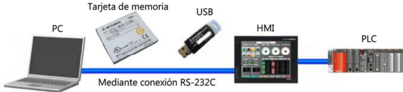
Utilizando simuladores de HMI tales como el GT Simulator3 de Mitsubishi Electric, los usuarios pueden usar un PC para verificar operaciones en pantalla sin conectarse realmente a una HMI.
