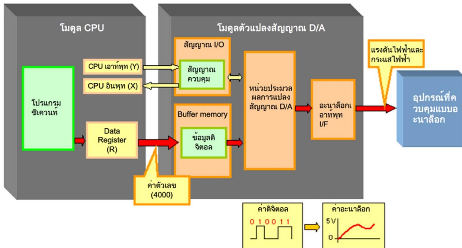
โมดูลตัวแปลงสัญญาณ D/A จะแปลงชุดข้อมูลดิจิทัลด้วยโปรแกรมซีแควนท์ เป็นข้อมูลอะนาล็อก (แรงดันไฟฟ้าหรือกระแสไฟฟ้า) จากนั้นจึงเอาท์พุทไปยังอุปกรณ์ภายนอก จะมีรายละเอียดอธิบายไว้ในบทที่ 2
