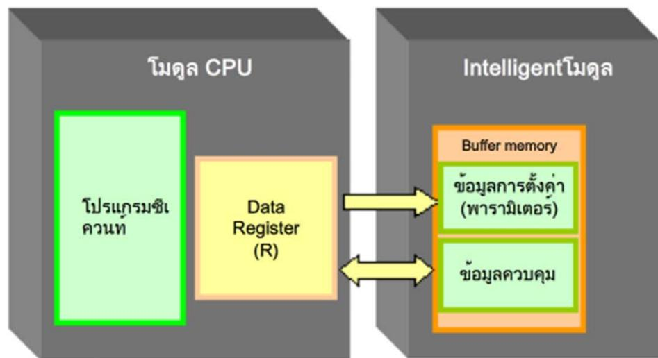
ตัวอย่างของข้อมูลการตั้งค่า (ในกรณีของโมดูลตัวแปลงสัญญาณ D/A)
