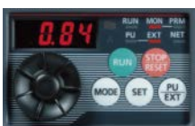
Ví dụ về màn hình hiển thị giám sát tiết kiệm điện năng
